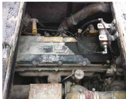
4A e 4B. Esempio di applicazione del sistema particulate-preventing (4A) e mezzo d'opera con applicazione del sistema particulate-preventing (4B)
